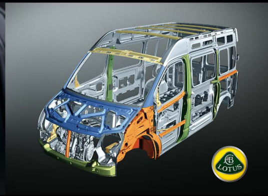
Eco-estructura fabricada por Lotus
